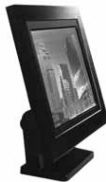
14型カラー TFT液晶 ディスプレイ試作品 (1988年)
